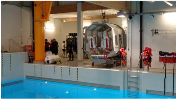
Trainingsszenarien sind beispielsweise der Notausstieg von Schiffen mit einem Maritime-Escape-System, der Überstieg zwischen Booten und das Befreien aus einem unter Wasser befindlichen Hubschrauber.
